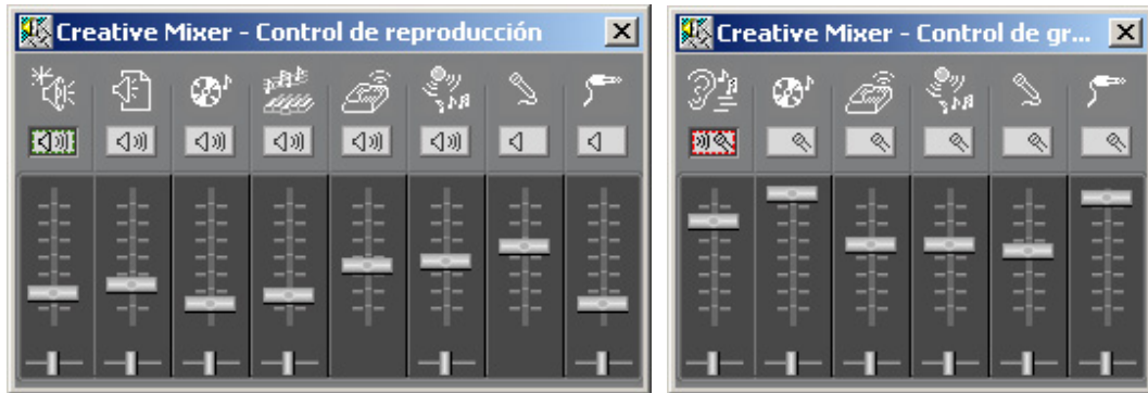
Controles de reproducción y grabación del mezclador de la tarjeta de sonido
